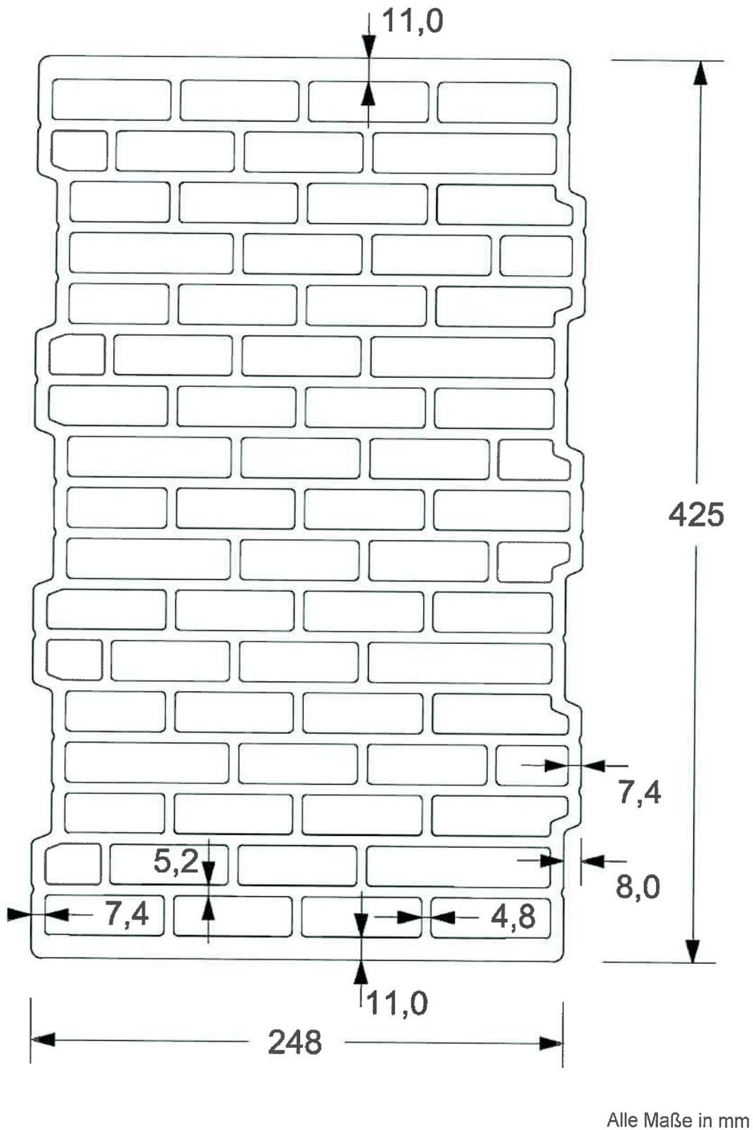
Mauerwerk aus Planhochlochziegeln T7 PA und T8 PA mit integrierter Wärmedämmung
