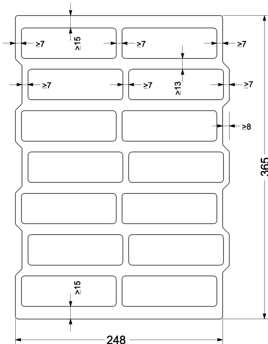
Alternative Stirflächenausbildung unter Einbehaltung der Mindeststegdicken möglich
