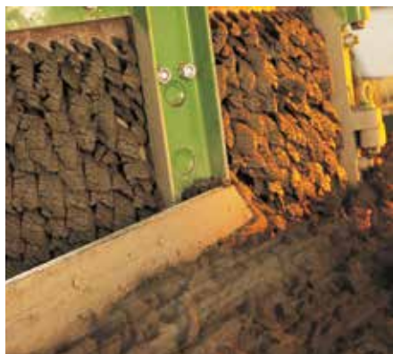
1.1b aufbereitete Ziegelmasse
