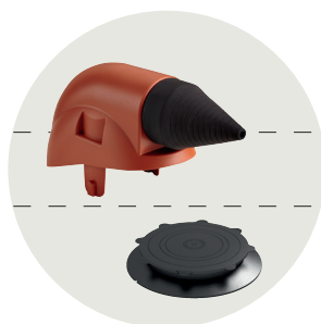
Solardurchgang aus Kunststoff, Universal Unterdachanschlusssadapter, zur Durch- führung von Leitungen und Kabeln mit Ø 10-70 mm
