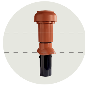
Entlüfterstützen lang DN 100 aus Kunststoff, Dachneigung 20°-50°, einschließlich Regenkappe
