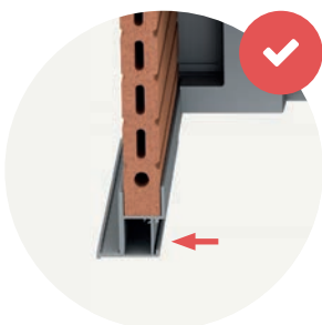
Verlängerte Abschlussleiste Um 4 cm verlängert, zur Vergröße- rung der Schachthöhe und dadurch „Verkleidung“ höherer Raffstore- pakete
