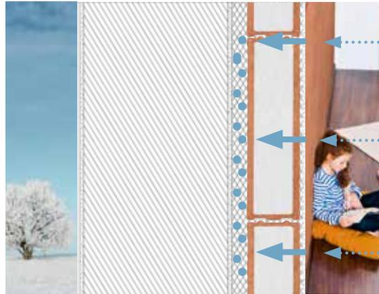
Warme Luft ist feuchter als kalte Luft. Durch diese Temperaturdifferenz zwischen innen und außen kommt es zu Dampfdruckdifferenzen. Wasserdampf gelangt in die Wandkonstruktion.
