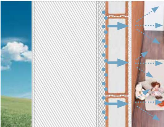
Durch die porige Struktur des WDF®-Ziegels wird die Feuchtigkeit an die Wandoberfläche transportiert (Kapillartransport). Von dort wird sie an die Raumluft abgegeben. Gleichzeitig werden Feuchtespitzen aus der Raumluft abgepuffert.
