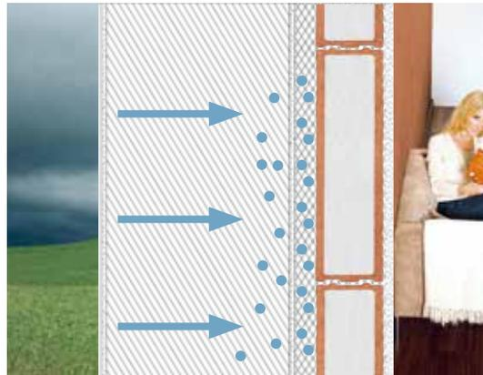
Durch Bewitterung gelangt unter Umständen Feuchtigkeit in die Konstruktion. Verputzte Fassaden oder ein ausreichender Dachüberstand können die Schlagregenbelastung deutlich reduzieren.
