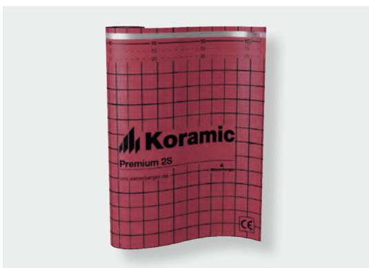
Die **Premium 2S** wiederum besitzt eine besonders hochwertige Polyurethan-Beschichtung und ist dadurch besonders abriebfest, beständig gegen Öl, zum Beispiel von Motorsägen, sowie bis zu 3 Monate frei bewitterbar. Zusätzlich besitzt sie die Feuerwiderstandsklasse B1 schwer entflammbar.
