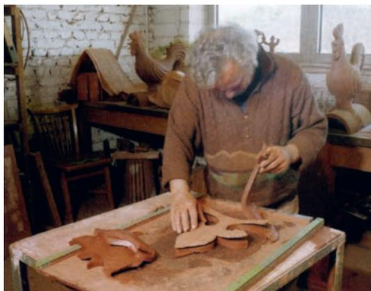
Das überschüssige Material wird entfernt, um den Schmuck dann mit dem vorgefertigten Firstziegel zu verbinden.
