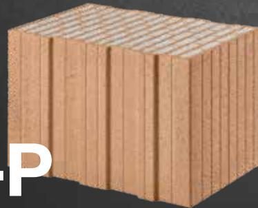
Beste Werte für jede Anforderung: Die U-Werte reichen von beachtlichen 0,14 bei einer Wandstärke von 49,0 cm bis hin zu 0,18 bei einer 36,5 cm dicken Wand! Mit der Wärmeleitfähigkeit von 0,070 W/(mK) erfüllt der Poroton-T7-P die strengen Anforderungen an die Gebäudehülle von KfW-Effizienzhäusern 40 (KFN) in 49,0 und 42,5 cm Stärke.
