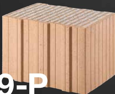
Der weiterentwickelte Poroton-S9-P ist der stabilste Perlit verfüllte Ziegel mit sehr hoher Tragfähigkeit. Der massive Ziegelkörper gibt statische Sicherheit und mit der Mauerwerksdruckfestigkeit von  $5,2 \text{ MN}/\text{m}^2$  meistert er die höchsten Belastungen im mehrgeschossigen Wohnungsbau.
