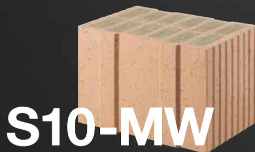
Mit der Druckfestigkeitsklasse 12 und einer char. Mauerwerksdruckfestigkeit von 5,2 MN/m<sup>2</sup> erreicht der Poroton-S10-MW einen Spitzenwert unter den Monolithen. Er sorgt übrigens nicht nur für die nötige baustatische Stabilität, sondern erfüllt mit der passenden Anlagentechnik auch die Anforderungen des Gebäudeenergiegesetzes (GEG).
