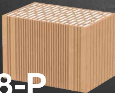
Die optimierte Lochgeometrie sorgt für hervorragenden Schall- und Wärmeschutz in Kombination. Die innovative Mikroverzahnung mit vielen kleinen Luftkammern vermindert den Wärmeverlust über die Stoßfuge. Das Ergebnis: Eine massive Ziegelwand mit U-Werten bis  $0,16 \text{ W}/(\text{m}^2\text{K})$ ! Der Poroton-S8-P ist somit der optimale Ziegel für den Objektbau, geeignet auch für KfW-Effizienzhäuser 40 NH.
