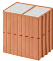
Schnitt 2: WDF-Ausgleichsziegel in der Länge halbiert
